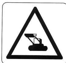
MÀQUINA PESANT EN MOVIMENT
